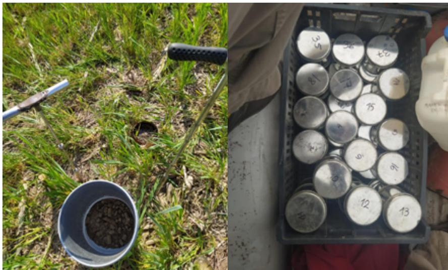
Figura 2. Extracción de muestras para análisis de variables químicas (izquierda) y contenido hídrico (derecha).
