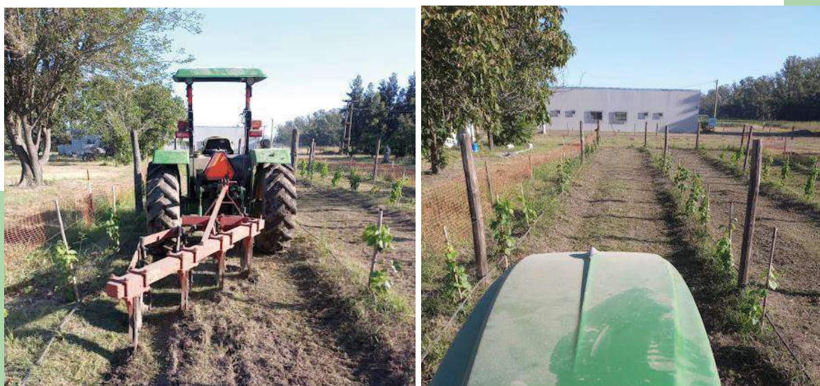
Figura 1. Izq. Subsolarador para mejorar la oxigenación y la permeabilidad del suelo. Der. Espalderos y distribución de la plantación. Ambos en Módulo de Fruticultura, FCA, UNR.
