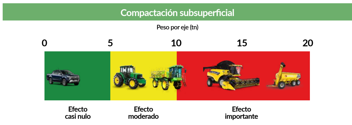
Figura 1. Riesgo de compactación subsuperficial según el peso por eje -de menor (izq.) a mayor (der.)- de distintas maquinarias comúnmente utilizadas en sistemas agrícolas de la Región Pampeana.
